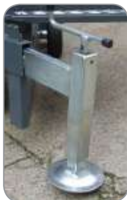
Estabilizadores extraíbles con husillos niveladores
