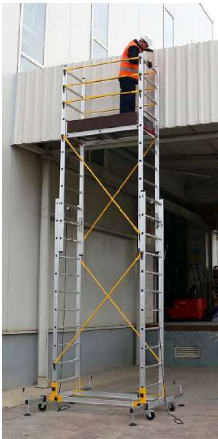
Base provista de estabilizadores extraíbles y husillos regulables para salvar hasta 26 cm de desniveles
