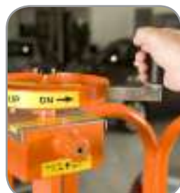
Elevación manual con ayuda de una manivela
