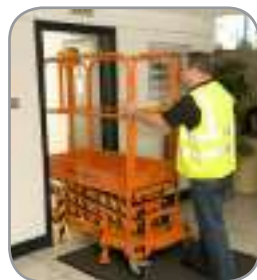
Cerrado pasa por puertas y pasillos
